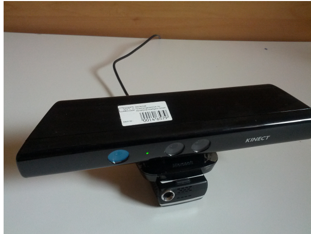
Abbildung 4.1: Prototyp aus Kinect und Mini-Projektor.
